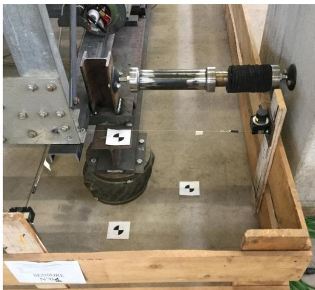
Viene posto un sensore di fine corsa su ogni pistone, che si attiverà nel momento di un possibile raggiungimento dello spostamento massimo calcolato nel progetto. Inoltre il sistema invierà un segnale di allarme ai relativi proprietari della struttura ed alla ditta incaricata alla manutenzione, in modo da ridurre al minimo i costi di verifica e ripristino.
